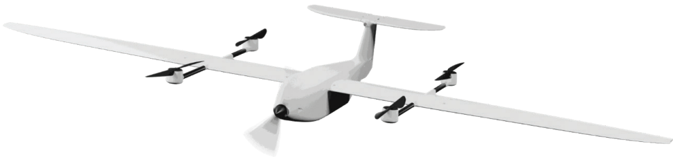
Rys. 3. Dron o konstrukcji płatownca firmy BZB UAS model ecoSKY 2.0
